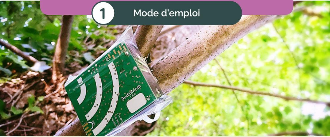
L'enregistreur AudioMoth permet d'enregistrer les ultrasons des chiroptères mais également ceux des orthoptères (les criquets par exemple). Il est nécessaire de le configurer à chaque enregistrement. Cela permet de choisir notamment les heures du début et de fin de l'enregistrement nocturne et de déterminer les différents paramètres d'enregistrement. Ce document présente les étapes nécessaires à sa configuration.
